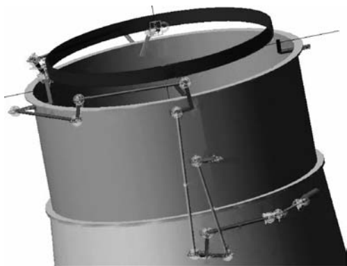
图 2 放气活门机构仿真模型 1
