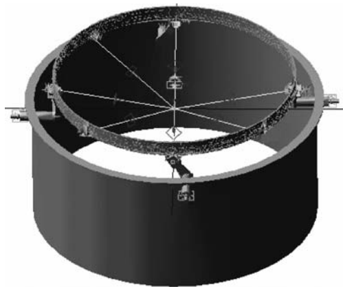
图 3 放气活门机构仿真模型 2
